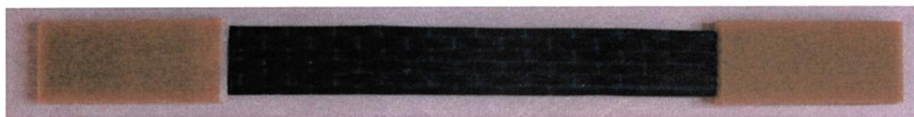
Рисунок 1 – Подготовленный к испытаниям образец холста MasterBrace Fib CF 230/4300.300g
