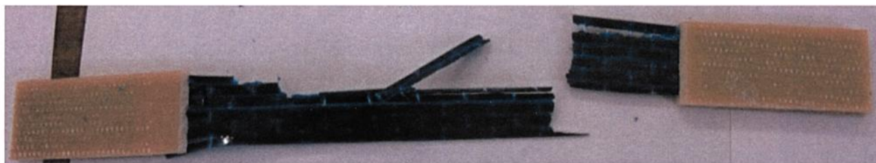
Рисунок 2 – Разрушенный образец холста MasterBrace Fib CF 230/4300.300g
