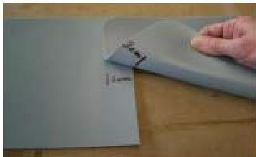
4.4.7. Соединить вместе две ошкуренные и очищенные части лент.
