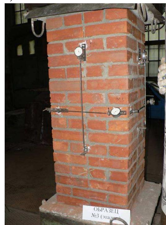
**Рис. 7.12. Общий вид опытных образцов кирпичных столбов V серии (а,б) и эталонного образца (в) до испытаний**
