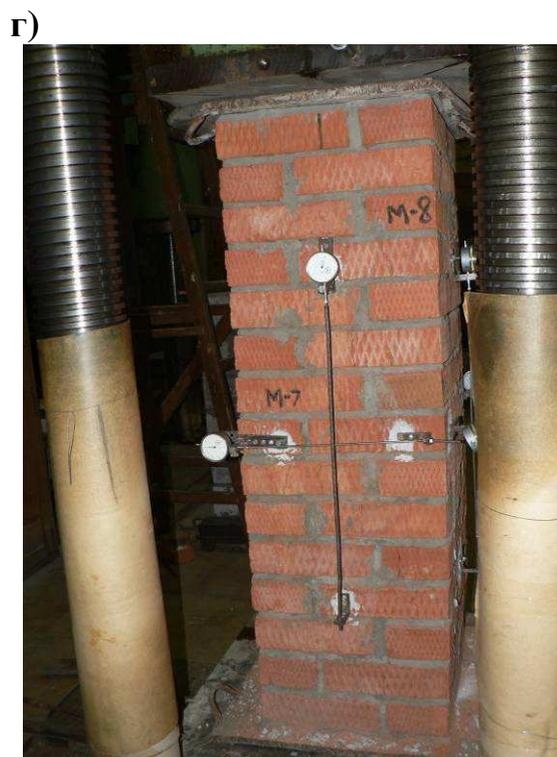
**Рис. 7.3. Общий вид опытных образцов кирпичных столбов III серии (а,б,в) и эталонного образца (г) до испытаний**
