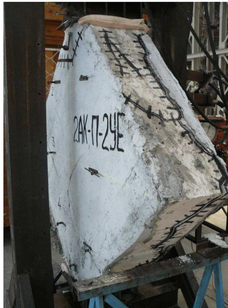
**Рис. 4.18. Общий вид в прессе до испытаний (а) и характер разрушения после испытаний (б) опытных образцов (VII серия) (ЗАО «Аэробел»)**
