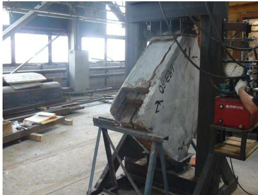
**Рис. 8.14. Общий вид в прессе до испытаний (а) и характер разрушения после испытаний (б) опытных образцов (VI серия)**
