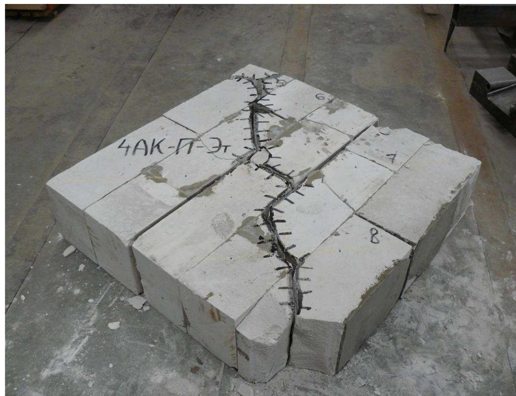
**Рис. 4.10. Общий вид в прессе до испытаний (а) и характер разрушения после испытаний (б) эталонных образцов (I серия) (ЗАО «АэроБел»)**
