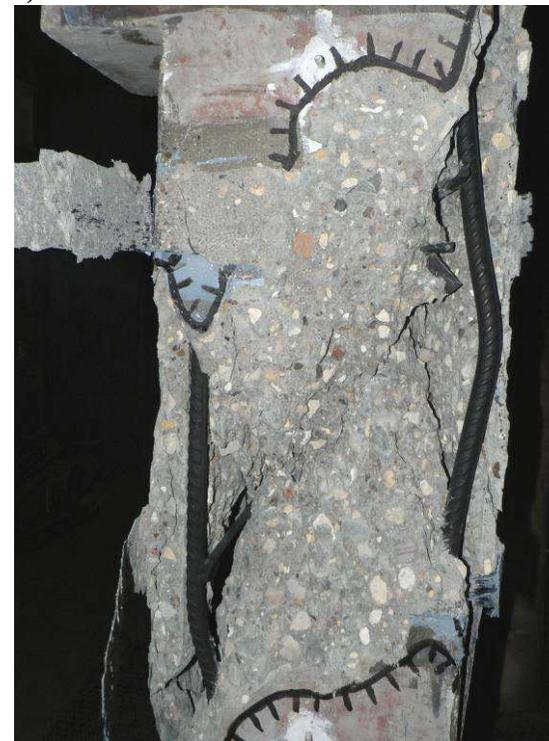
**Рис.10.13. Характер разрушения опытного образца фрагмента железобетонной колонны II, изготовленной из тяжёлого бетона**
