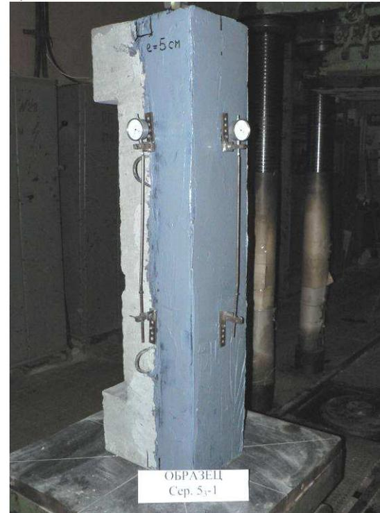
**Рис.10.14. Общий вид опытных образцов фрагментов железобетонных колонн III серии, изготовленных из тяжёлого бетона, до начала испытаний**
