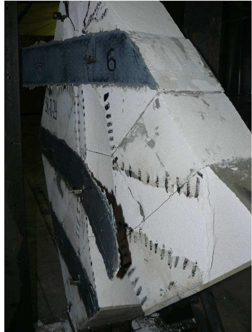
**Рис. 4.13. Общий вид в прессе до испытаний (а) и характер разрушения после испытаний (б) опытных образцов (III серия) (ЗАО «Кселла-Аэроблок-Центр»)**
