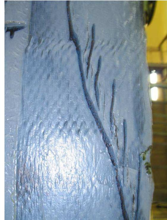
**Рис. 10.16. Характер разрушения опытного образца фрагмента железобетонной колонны III серии К<sub>уг</sub> 3-3**
