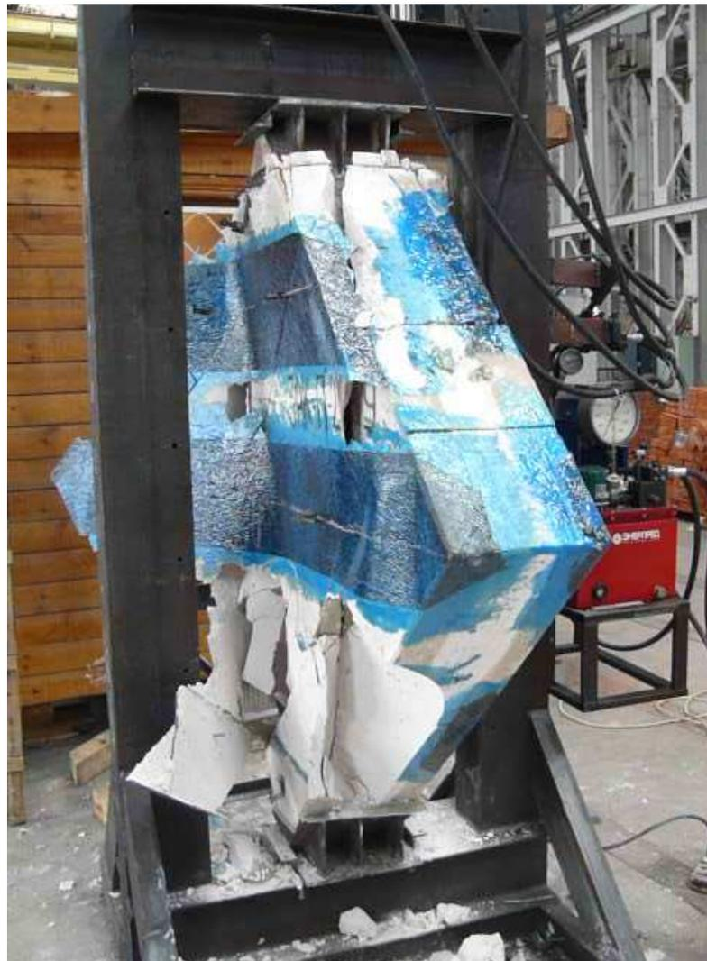
**Рис. 4.14. Общий вид в прессе до испытаний (а) и характер разрушения после испытаний (б) опытных образцов (III серия) (ЗАО «АэроБел»)**
