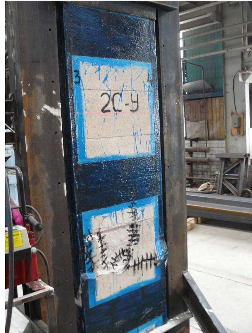
**Рис. 5.7. Общий вид в прессе до испытаний (а) и характер разрушения после испытаний (б) образцов II серии**
