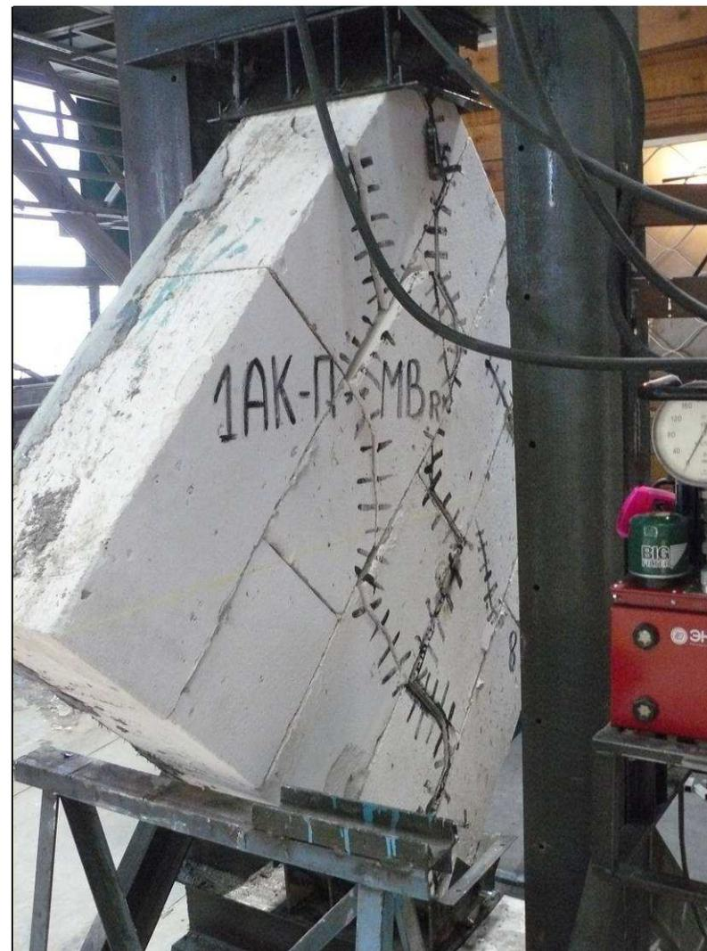
**Рис. 4.17. Общий вид в прессе до испытаний (а) и характер разрушения после испытаний (б) опытных образцов (VI серия) (ЗАО «АэроБел»)**
