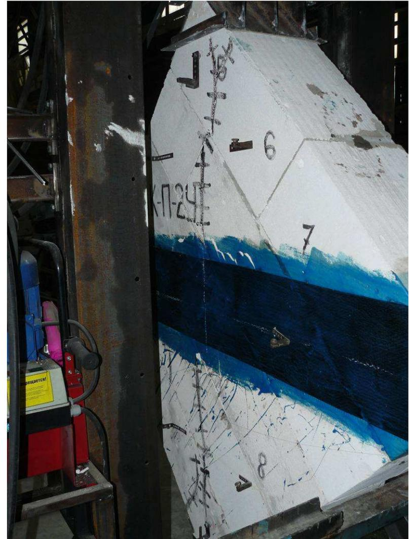
**Рис. 4.16. Общий вид в прессе до испытаний (а) и характер разрушения после испытаний (б) опытных образцов (V серия) (ЗАО «АэроБел»)**
