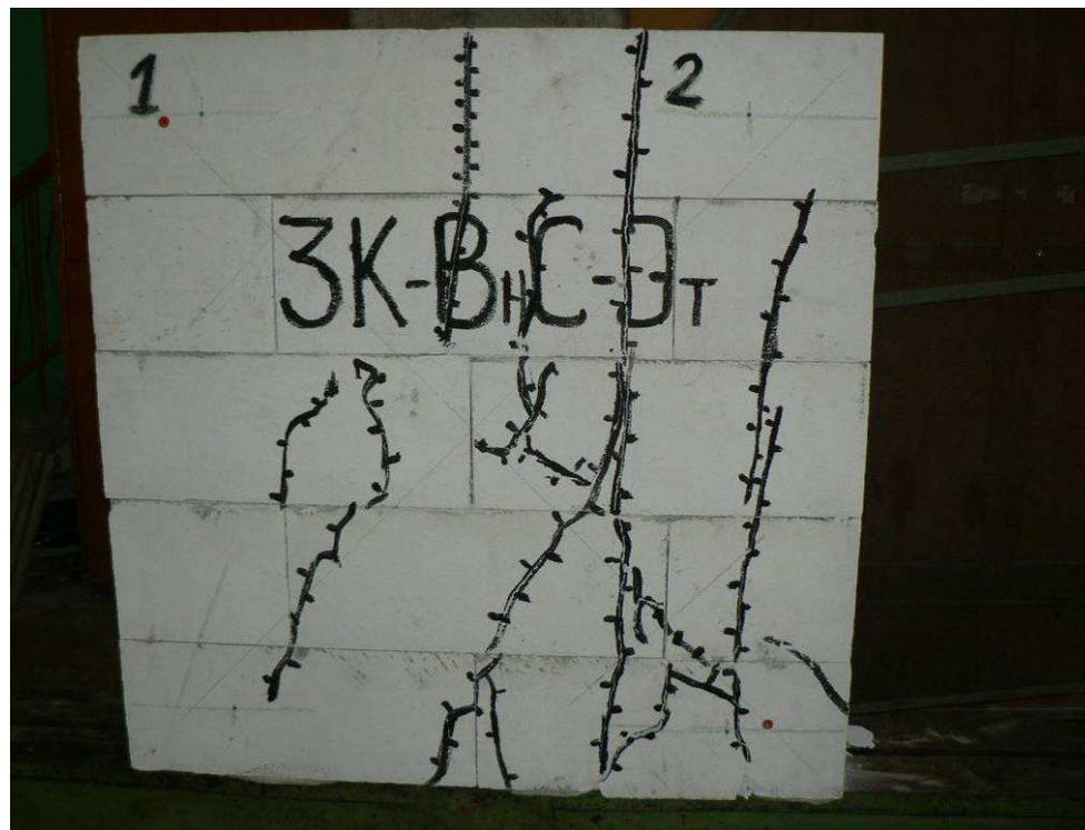
Рис. 5.9. Общий вид в прессе до испытаний (а) и характер разрушения после испытаний (б) образцов III серии
