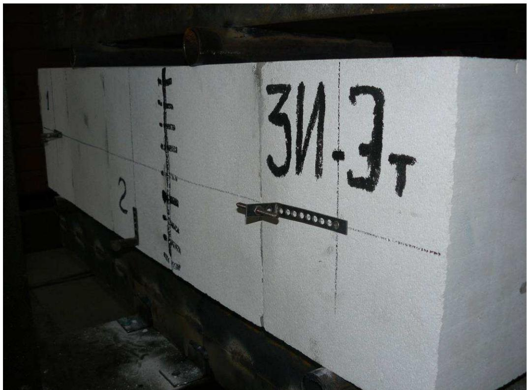
**Рис. 6.4. Общий вид в прессе до испытаний (а) и характер разрушения после испытаний (б) образцов I серии**
