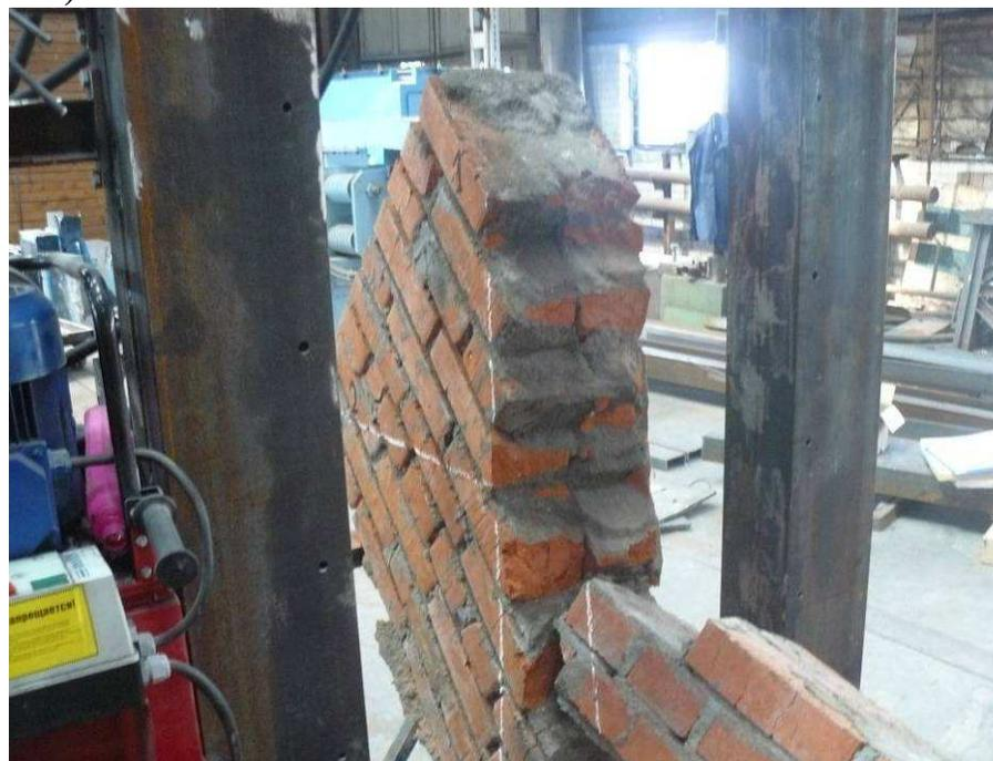
**Рис. 8.12. Общий вид в прессе до испытаний (а) и характер разрушения после испытаний (б) опытных образцов IV серия**
