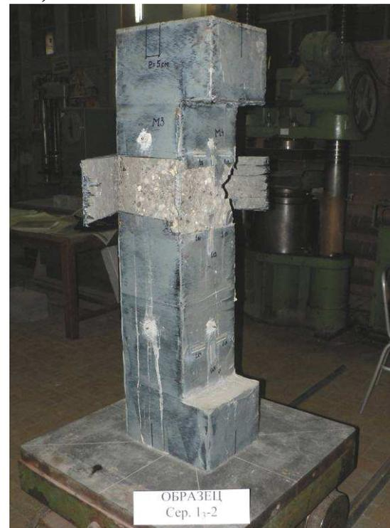
**Рис. 10.10. Характер разрушения опытных образцов фрагментов железобетонных колонн I серии:  $K_{yT}1-1$ (а,б) и  $K_{yT}1-3$  (в)**
