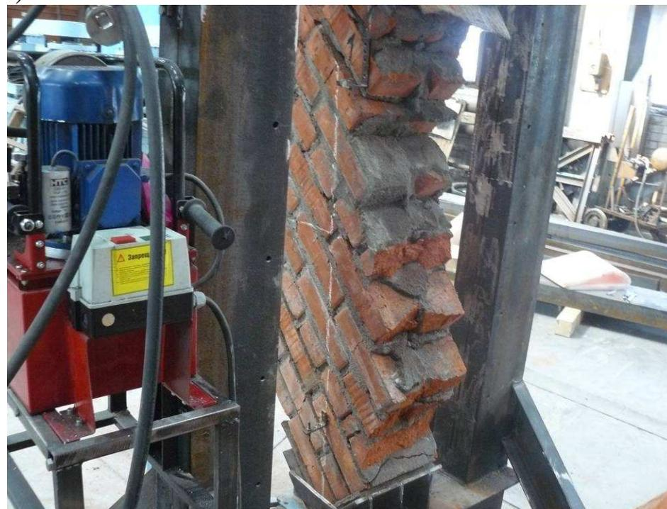
**Рис. 8.9. Общий вид в прессе до испытаний (а) и характер разрушения после испытаний (б) эталонных образцов (I серия)**
