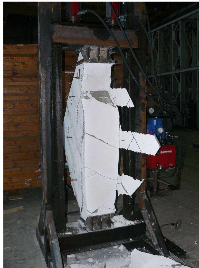
**Рис. 4.11. Общий вид в прессе до испытаний (а) и характер разрушения после испытаний (б) опытных образцов (II серия) (ЗАО «Кселла-Аэроблок-Центр»)**
