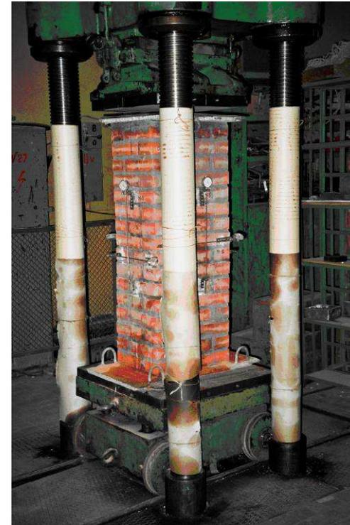
**Рис. 7.5. Общий вид опытных образцов кирпичных столбов II серии (а,б) и эталонного образца (в) до испытаний**
