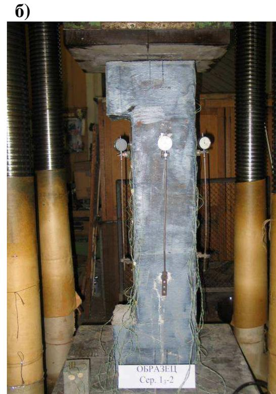
**Рис. 10.9. Общий вид опытных образцов фрагментов железобетонных колонн I серии в прессе до начала испытаний**
