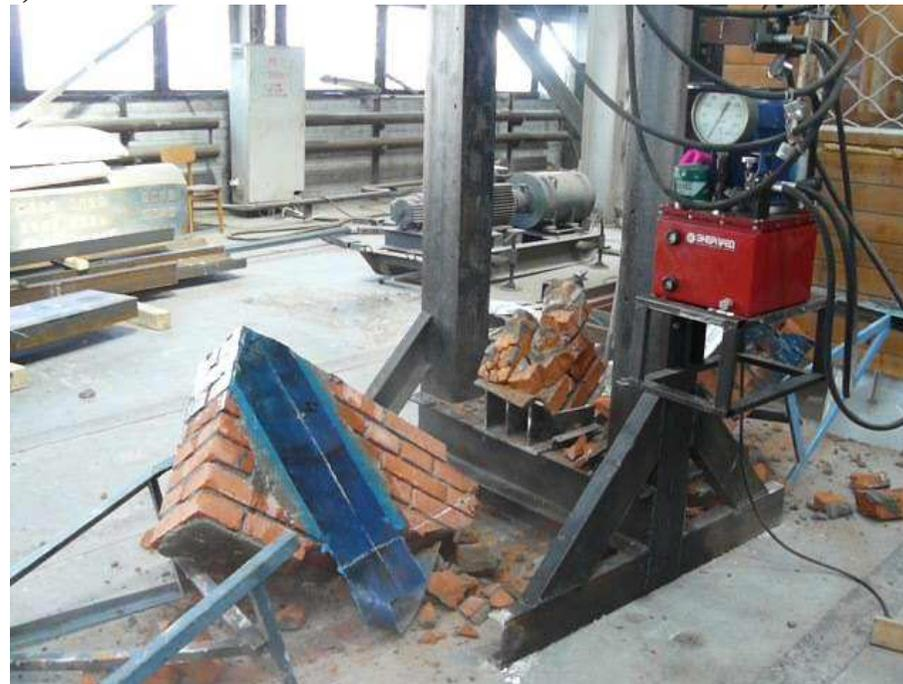
**Рис. 8.15. Общий вид в прессе до испытаний (а) и характер разрушения после испытаний (б) опытных образцов (VII серия)**
