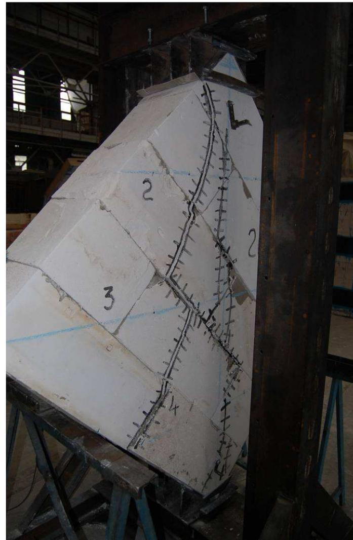
**Рис. 4.15. Общий вид в прессе до испытаний (а) и характер разрушения после испытаний (б) опытных образцов (IV серия) (ЗАО «АэроБел»)**
