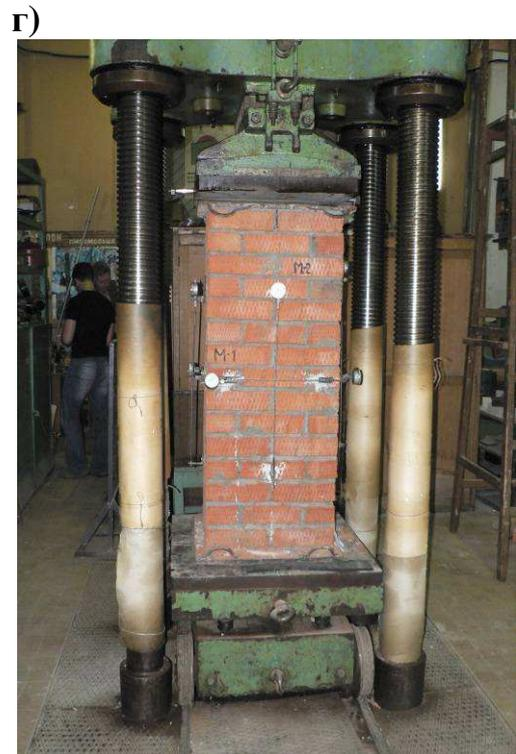
**Рис. 7.10. Общий вид опытных образцов кирпичных столбов IV серии (а,б,в) и эталонного образца (г) до испытаний**
