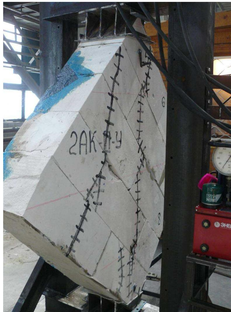
**Рис. 4.12. Общий вид в прессе до испытаний (а) и характер разрушения после испытаний (б) опытных образцов (II серия) (ЗАО «АэроБел»)**
