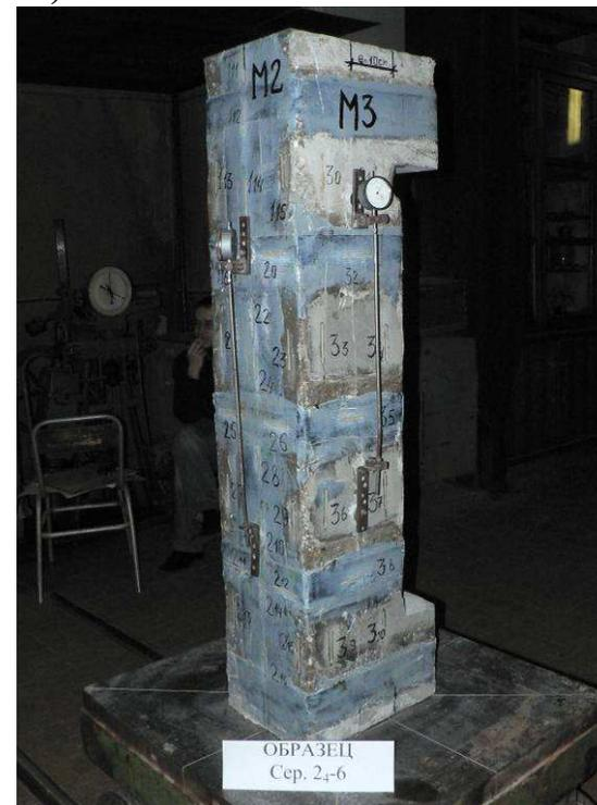
**Рис. 10.12. Общий вид опытных образцов фрагментов железобетонных колонн II серии, изготовленных из тяжёлого бетона, в прессе до начала испытаний**
