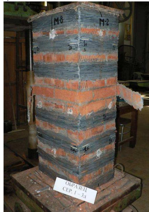
**Рис. 7.4. Характер разрушения опытных образцов кирпичных столбов I серии**
