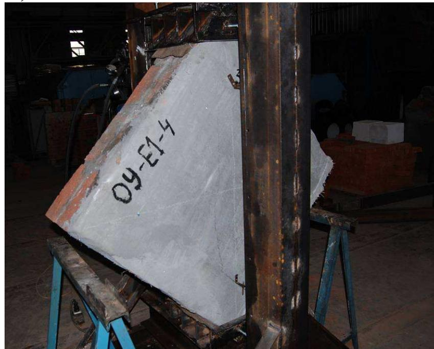
**Рис. 8.11. Общий вид в прессе до испытаний (а) и характер разрушения после испытаний (б) опытных образцов (III серия)**
