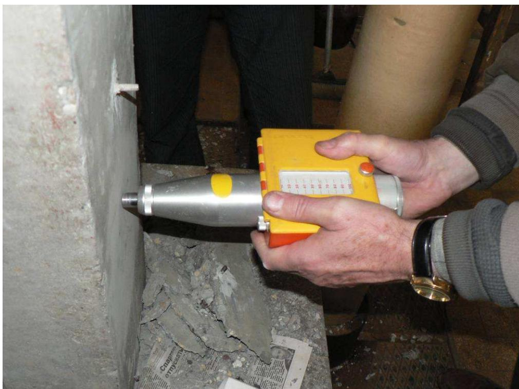
**Рис.10.4. Определение прочности бетона молотком Шмидта**
