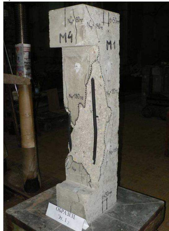
**Рис. 10.7. Общий вид эталонного образца марки Э<sub>к</sub>1-3, изготовленного из тяжёлого бетона, до и после испытаний (образец устанавливался с эксцентриситетом  $e=50\text{мм}$ )**
