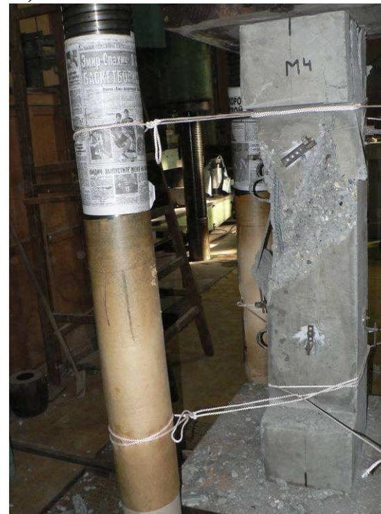
Рис. 10.6. Общий вид эталонного образца марки Э<sub>к</sub>1-1до (а) и после (б, в) испытаний
