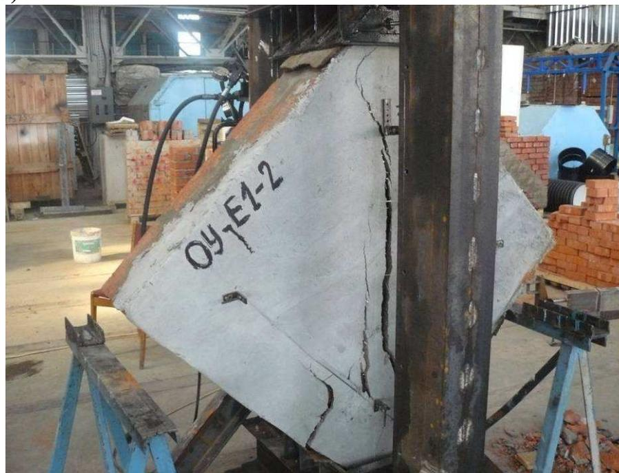
**Рис. 8.10. Общий вид в прессе до испытаний (а) и характер разрушения после испытаний (б) опытных образцов (III серия)**
