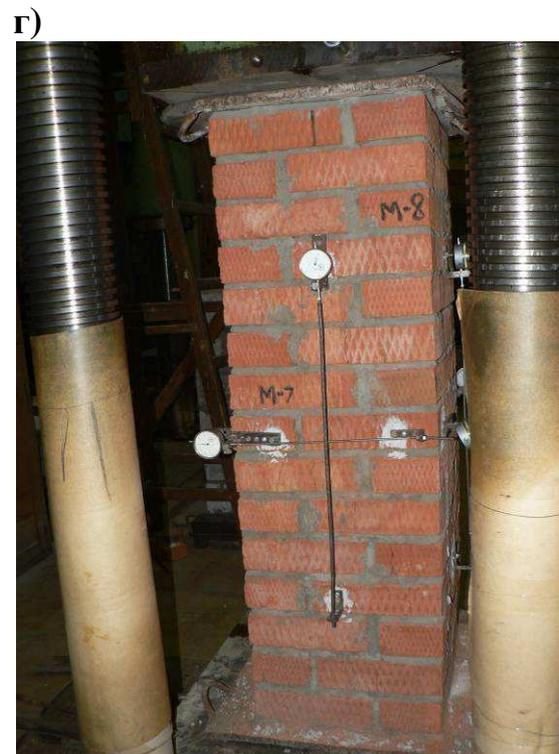
**Рис. 7.8. Общий вид опытных образцов кирпичных столбов III серии (а,б,в) и эталонного образца (г) до испытаний**
