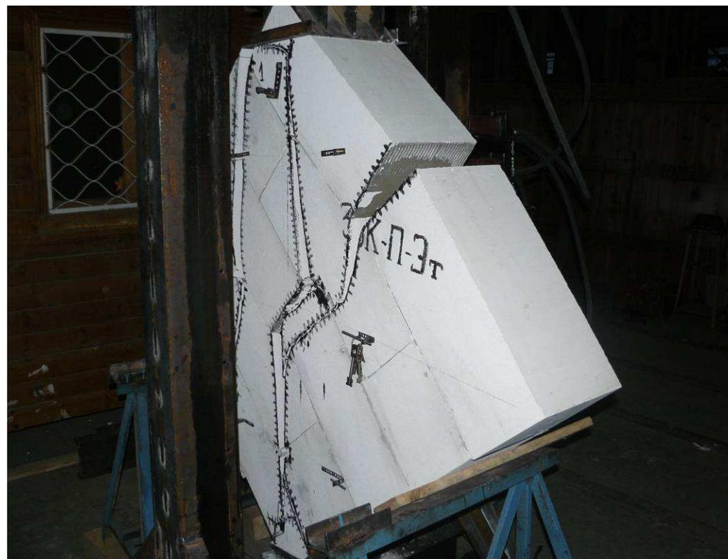
**Рис. 4.9. Общий вид в прессе до испытаний (а) и характер разрушения после испытаний (б) эталонных образцов (I серия) (ЗАО «Кселла-Аэроблок-Центр»)**
