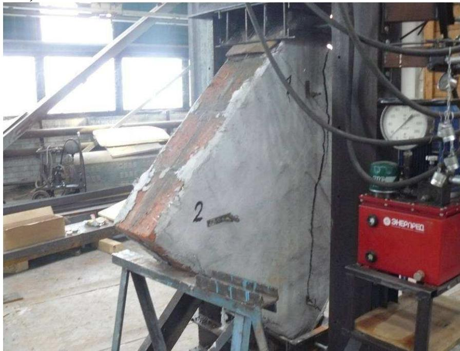
**Рис. 8.13. Общий вид в прессе до испытаний (а) и характер разрушения после испытаний (б) опытных образцов (V серия)**
