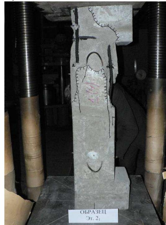
**Рис. 10.8. Общий вид эталонного образца марки Э<sub>к</sub>2-1, изготовленного из полимербетона, до (а) и после (б, в) испытаний**
