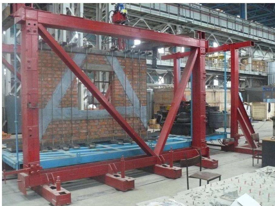
**Рис. 9.5. Схема проведения испытаний и расстановки датчиков**
