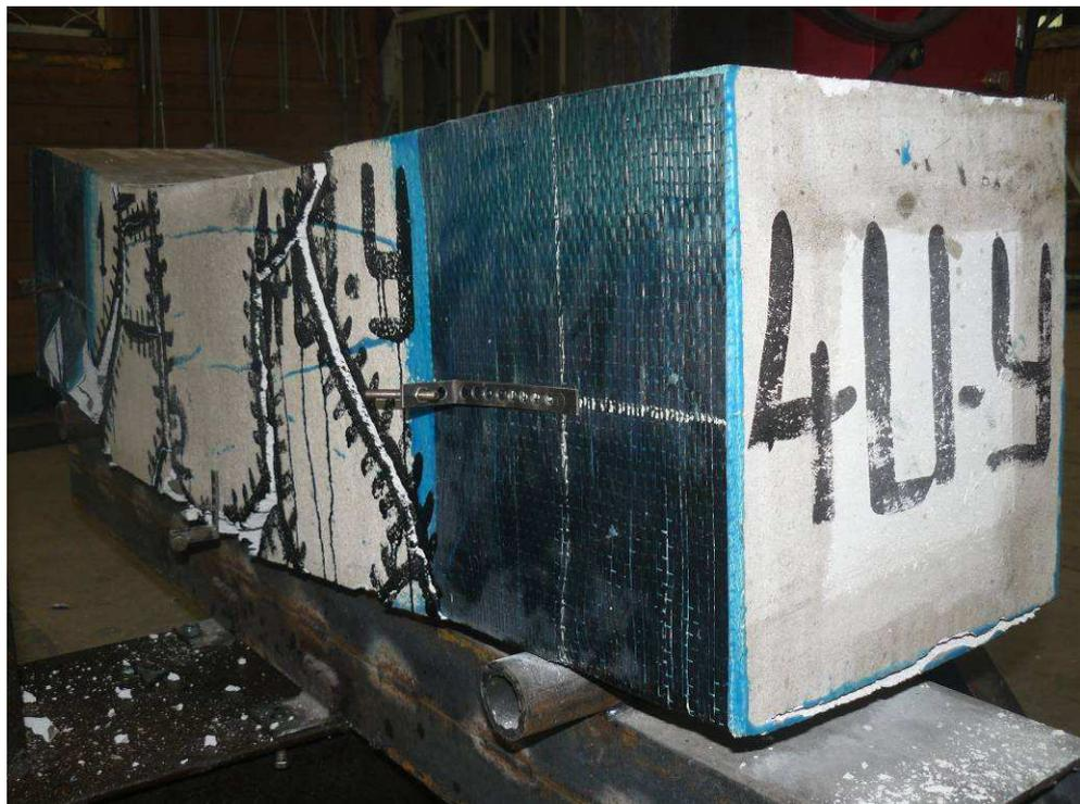
**Рис. 6.5. Общий вид в прессе до испытаний (а) и характер разрушения после испытаний (б) образцов II серии**
