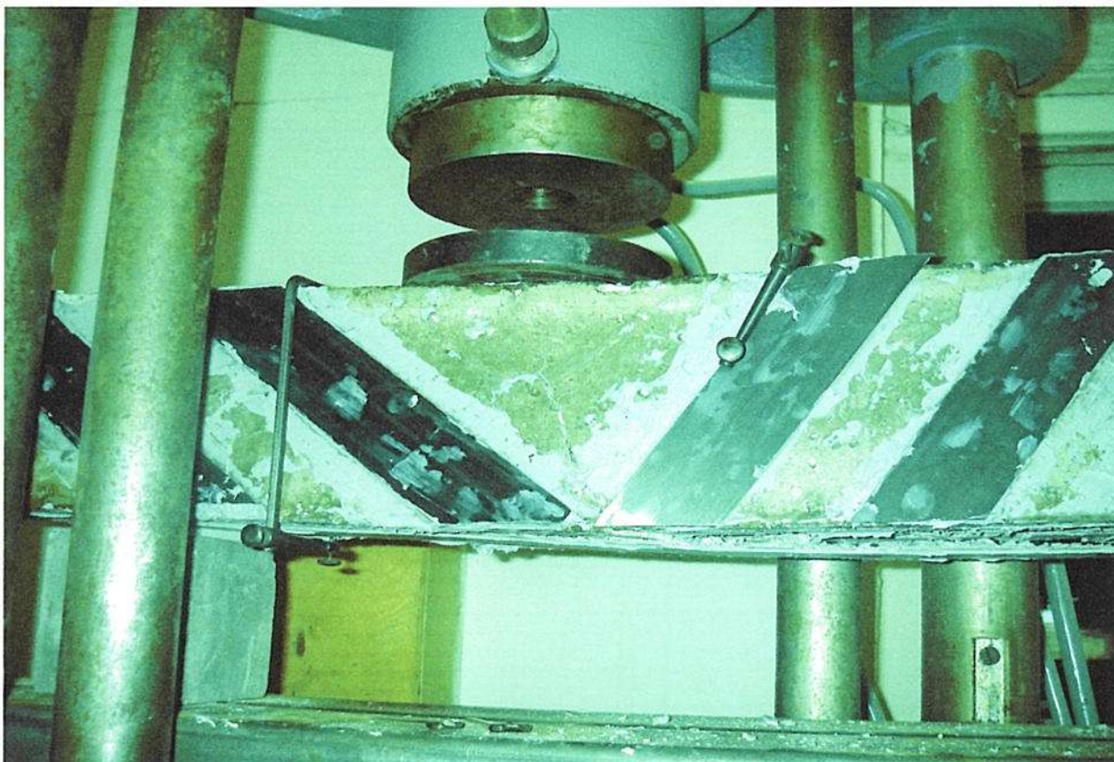
Схема разрушения перемычек по III схеме усиления
